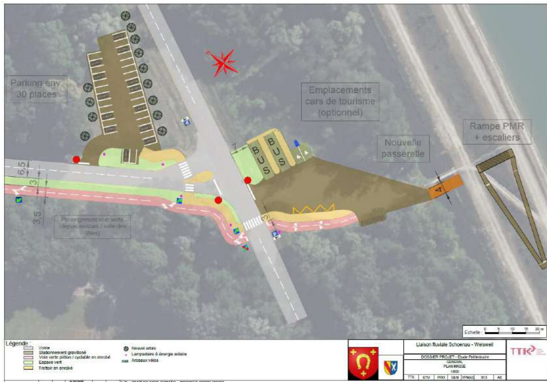
Abbildung15 : Plan Umbaumaßnahmen Szenarien 2 und 3 Kreuzung RD611 / RD52
